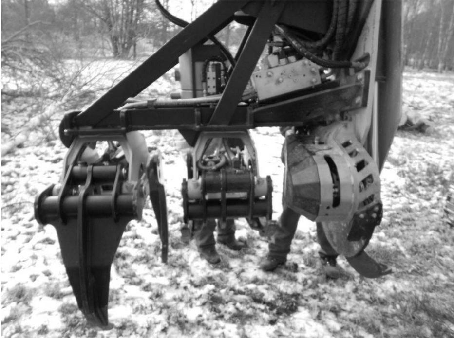
Bild 1: Greifer mit Kneifer und Säge am Arm eines mobilen Baggers
