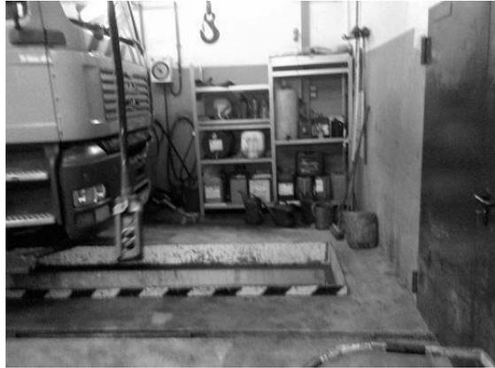
Eine Absicherung der angehobenen Schüttung mittels Kran und ein Arbeiten an einer komplett ausgefahrenen Schüttung sind aufgrund der zu niedrigen Deckenhöhe baulich nicht möglich. Um am Fahrzeugaufbau zu arbeiten, sind Mindestfreiräume durch die Unfallverhütungsvorschriften vorgeschrieben.
