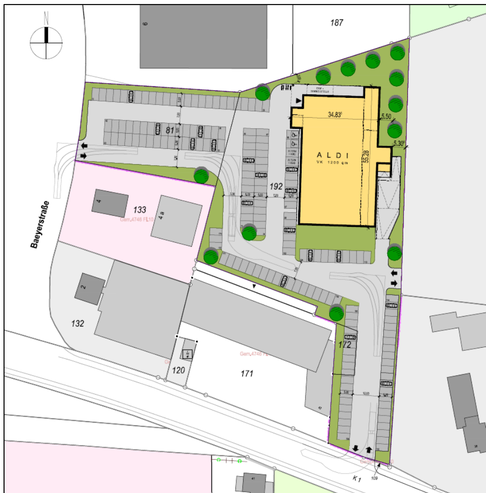
Bild 1.2: Erschließungskonzept (Architekten Amtage-Bremer-Marquardt, Stand 29.07.2015)
