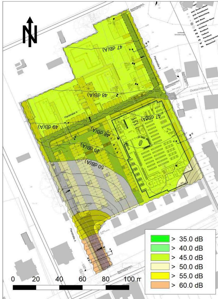
Abbildung 7 Maßgeblicher Außenlärmpegel für Räume, die überwiegend zum Schlafen genutzt werden können (Nebenzeichnung 2)
