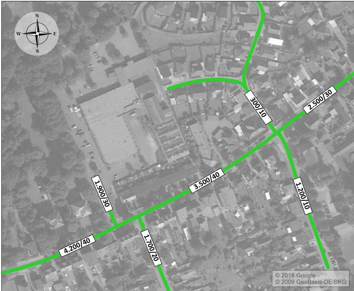
Bild 2.3: Analyse 2019 – DTV,  $DTV_{sv}$
