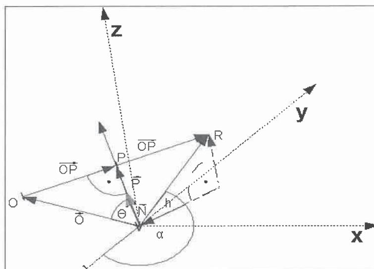
Abbildung 6: Geometrische Betrachtung der Reflexion am geneigten Modul
