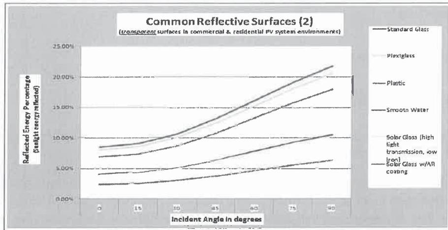
Abbildung 2: Reflexionsverhalten in Abhängigkeit vom Einfallswinkel<sup>3</sup>
