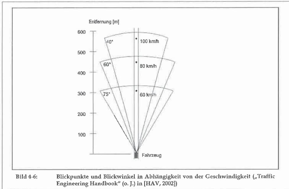
Abbildung 1: Öffnungswinkel Sehfeld in Abhängigkeit von der Geschwindigkeit<sup>2</sup>
